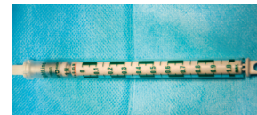
Abb. 4 Dynamometer (bestimmt die zwischen zwei Körpern wirkende Kraft)
