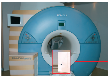
Abb. 5 Versuchsaufbau: Durch die entstehenden Kräfte abgelenkte Provox® ActiValve (extra strong) in einem Siemens Avanto MRT 1,5 T
